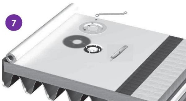
Découper la membrane d'étanchéité pour le passage de l'eau et des goujons de fixation. Consulter et appliquer les éventuelles dispositions particulières additionnelles du DTA de membrane concerné avant de serrer la bride sur la membrane via les vis de serrage
