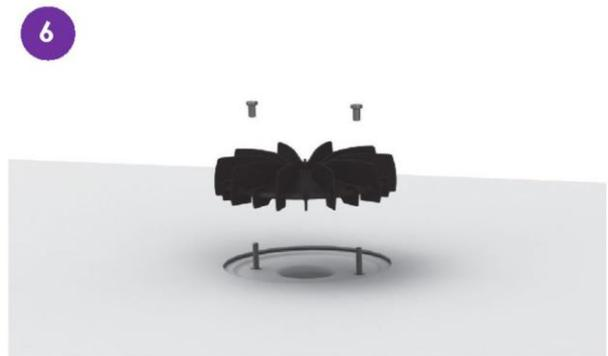
Découper la membrane d'étanchéité pour le passage de l'eau et des goujons de fixation. Après avoir découpé le trou pour le passage de l'eau et des goujons de fixation, positionner et fixer la crapaudine de naissance avec les 2 douilles taraudées prévues à cet effet.
