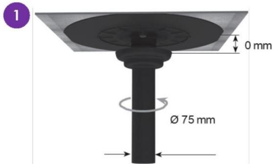
Assembler le connecteur de réseau siphôide en fonction de la nature de réseau siphôide (TPHP Akasison L ou PEHD Akasison XL)
