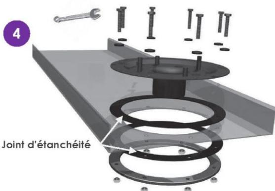
Assembler le bol sur le chéneau avec la bride et les joints d'étanchéité
