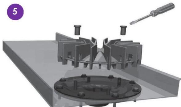
Monter le dispositif anti-vortex avec les douilles taraudées correspondantes
