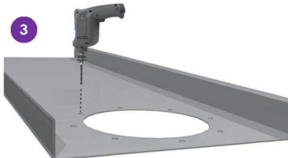
Percer les trous de fixation dans le chéneau diamètre 7 mm
