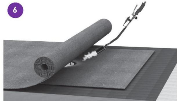
Souder à la flamme ouverte l'étanchéité bitume monocouche sur la platine de naissance et le plastron de renfort
