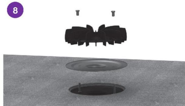
Positionner la platine anti-poinçonnement et fixer la crapaudine de naissance avec les 2 douilles taraudées prévues à cet effet.
