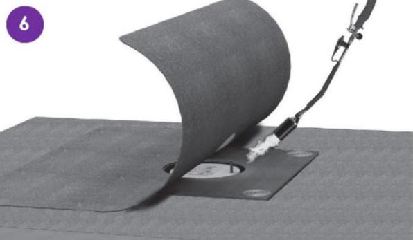
Conformément aux DTU en vigueur, constituer un plastron de renfort. Le souder à la flamme ouverte
